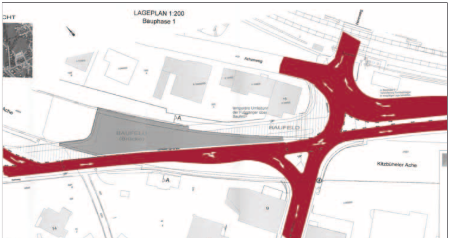
Während der Bauphase wird der Verkehr Richtung St. Johann über den Achenweg und Bahnhof geführt.
